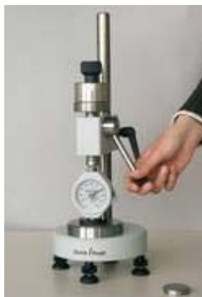
Figura 7. Probeta correspondiente a la norma ASTM D 2240.
