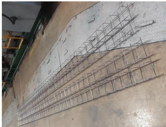
**Figura 3. Armaduras de castillo creadas durante las pruebas de calidad, matriz de  $37 \times 1$  elementos ( $\mathcal{M}_{37 \times 1}(\mathbb{C})$ ).**
