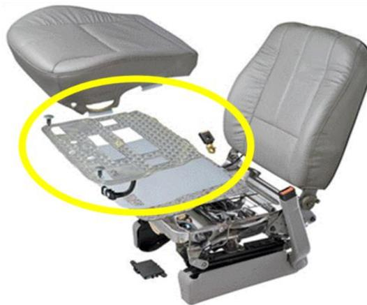
**Figura 1. Imagen de la estructura de un asiento de automóvil equipado con Bladder, señalando el componente con un círculo.**
