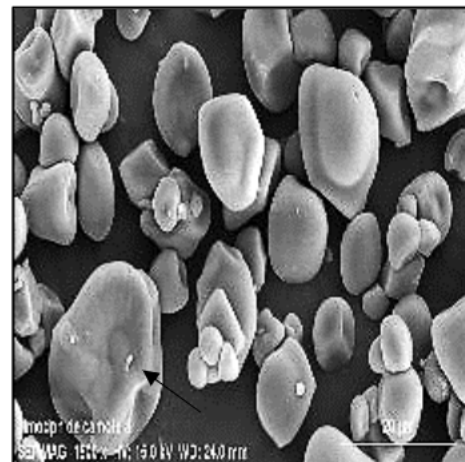
Figura 7. Gránulos fundidos del almidón de papa acetilado. 1500X
