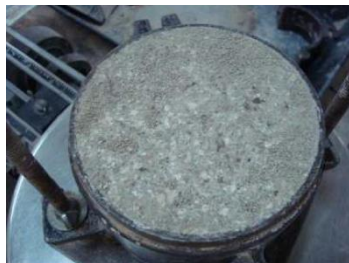
Figura 2. Estructura del suelo-cemento compactado.
