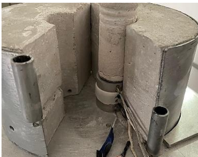
Figura 3. Diseño de guardas y acomodo de probetas. Fuente: Elaboración propia
