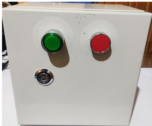
Figura 7. Fotografía del gabinete del control de riego automático para huerto de cocos
