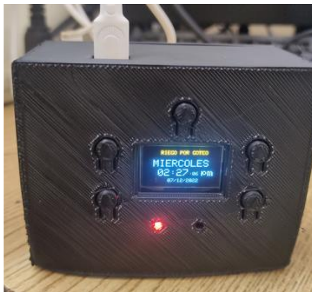
Figura 6. Fotografía que muestra el circuito de control electrónico automático de riego.
