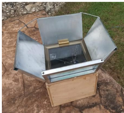
Figura 2. Horno solar B con 4 aletas reflectantes
