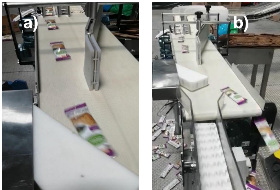
Figura 10. (a) guías ajustables y (b) Salida del producto hacia el centro de acumulación.
