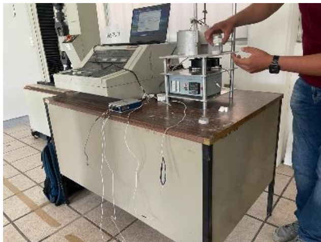
Figura 2. Equipo para medición de Conductividad Térmica (ASTM E1225-99). Fuente: Elaboración propia
