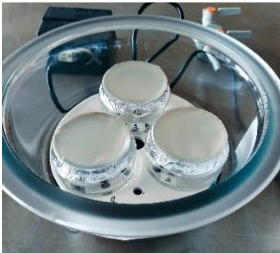
Figura 3. Preparación de las películas para la prueba de permeabilidad.
