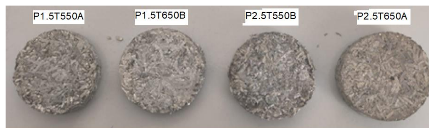
Figura 1 Disipadores de Calor de Esponjas Metálicas (DCEM) fabricados por Sinterización.
