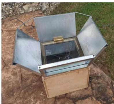
**Figura 2. Horno solar B con 4 aletas reflectantes**
