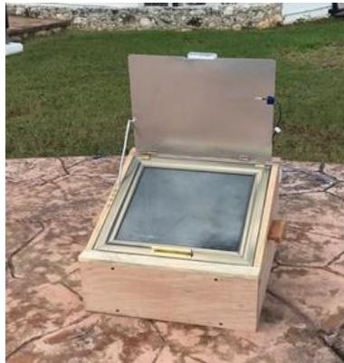
**Figura 1. Horno solar A con una aleta reflectante**
